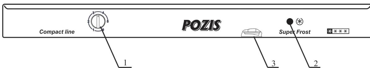
Рис.2 Схема расположения управления и сигнализации
