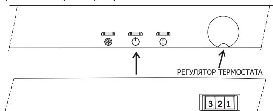
Термостат автоматически регулирует температуру внутри холодильной и морозильной камер. Путем изменения позиции ручки с MIN («1») на MAX («5») может быть достигнута более низкая температура.
